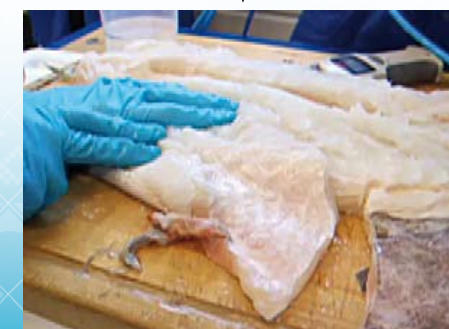
Fig. 13: Fjerning av svarthinne hos torsk med fryseelement
