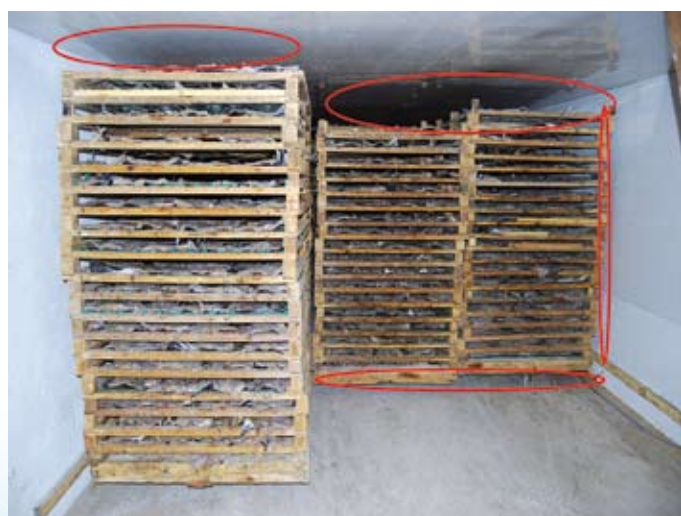
Fig. 1: Mye falskluft går gjennom tunneler med åpne kanaler. Utnytt tørkeluften ved å fylle tunnelen maksimalt, eller blend av kanaler for falskluft
